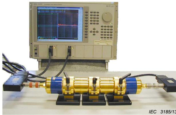
Figure 72 – S parameter test setup
