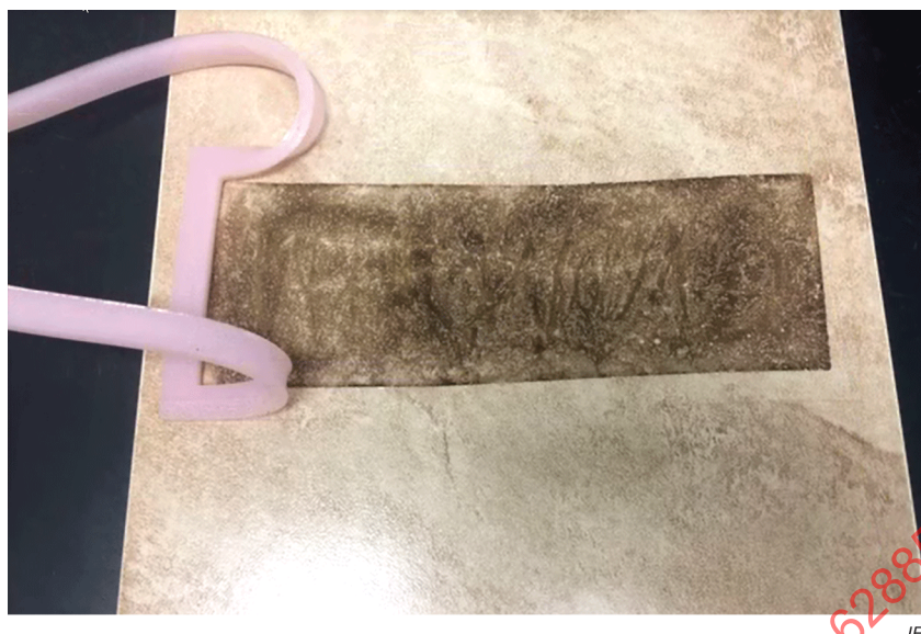
Figure 13 – Carreaux salis après 4 h de séchage
