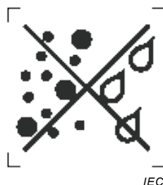
Figure 1 – Lampe non adaptée à une utilisation dans un environnement poussiéreux et humide
