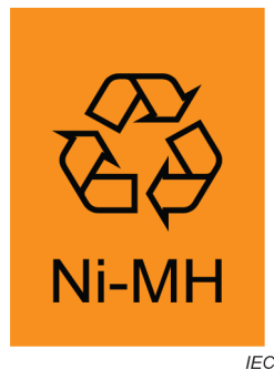
Figure 8 – Exemple de marquage des batteries au nickel-métal-hydrure avec symbole de recyclage
