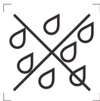
Figure 2 – Lampe non adaptée à une utilisation en présence de poussière et d'humidité
