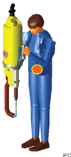
Figure 2 – Mesurage de l'exposition au niveau du tronc
