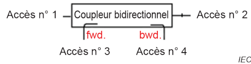
Figure D.5 – Numérotation d'accès pour les mesurages de paramètres S du coupleur directionnel
