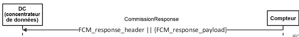
Figure D.6 – Réponse de mise en service
