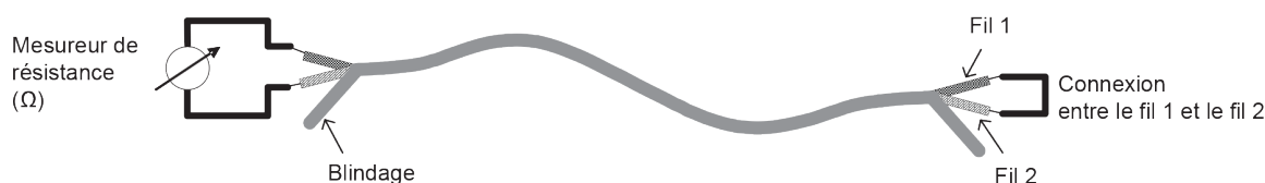
Figure N.1 – Mesure de la résistance de boucle fil à fil
