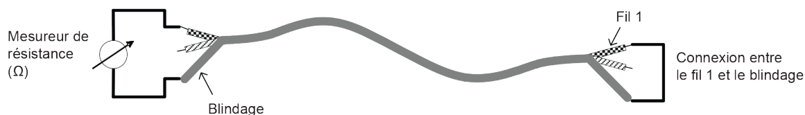
Figure N.2 – Mesure de la résistance de boucle fil 1/blindage
