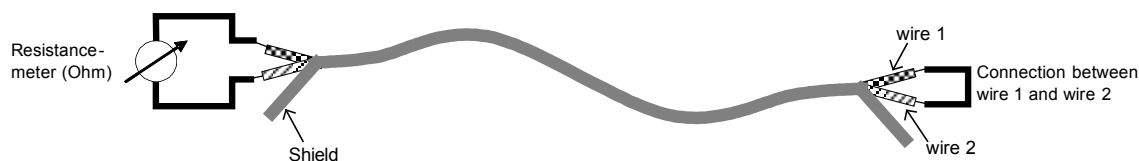
Figure N.1 – Loop resistance measurement wire to wire
