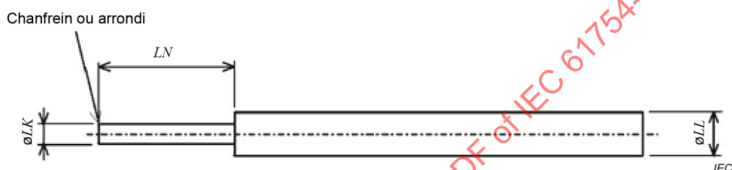
Figure 4 – Broche calibrée pour manchon d'alignement élastique
