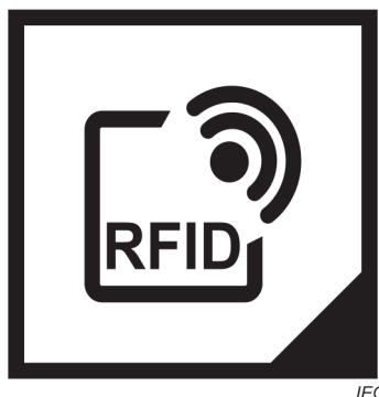
Figure 5 – Marquage d'une balise NFC pour indiquer l'existence d'un IL
