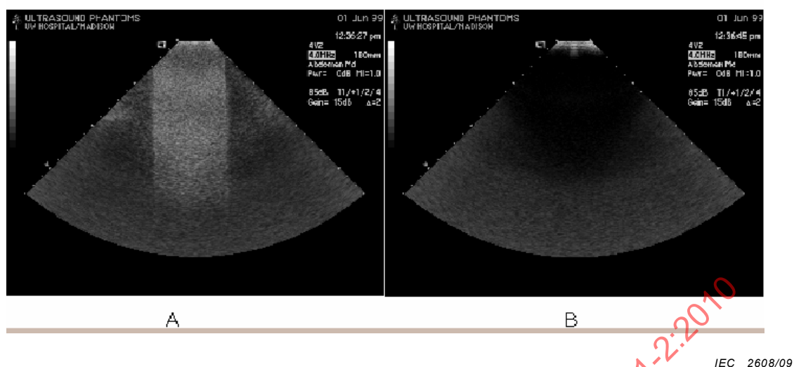
A) Image d'une section uniforme d'un fantôme d'imitation du tissu; B) Image montrant le bruit électronique seul, obtenu avec les commandes du scanner réglées de la même manière que pour A, mais avec le transducteur découplé du fantôme.
