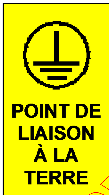
Figure 4 – Exemple d'étiquette pour des points de liaison à la terre désignés des GRVS de Type C
