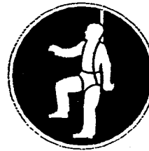
Protection obligatoire individuelle contre les chutes
