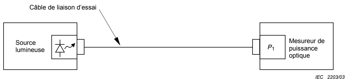
Figure 3 – Mesure de la puissance de référence pour la méthode 2
