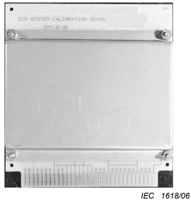
Figure 6 – Carte de vérification de la résistance avec capuchon protecteur
