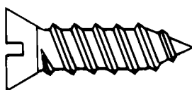
Figure 1 – Vis autotaraudeuse par déformation de matière (3.6.10)
