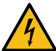
Figure O.1 – Marquage des composants électriques de la classe de tension de batterie B
