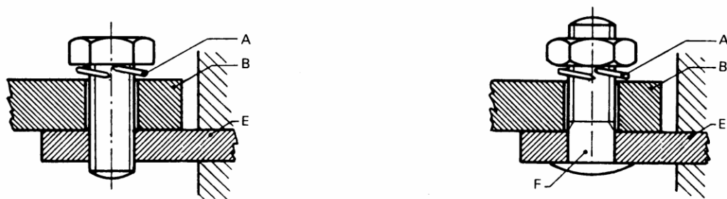
A Dispositif de blocage B Cosse ou barre E Partie fixe F Goujon
