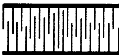
Figure 6 – Pondération par apodisation obtenue en modifiant la longueur d'emboîtement des doigts
