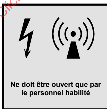
Figure 1b) – Étiquette sur les portes de maintenance
