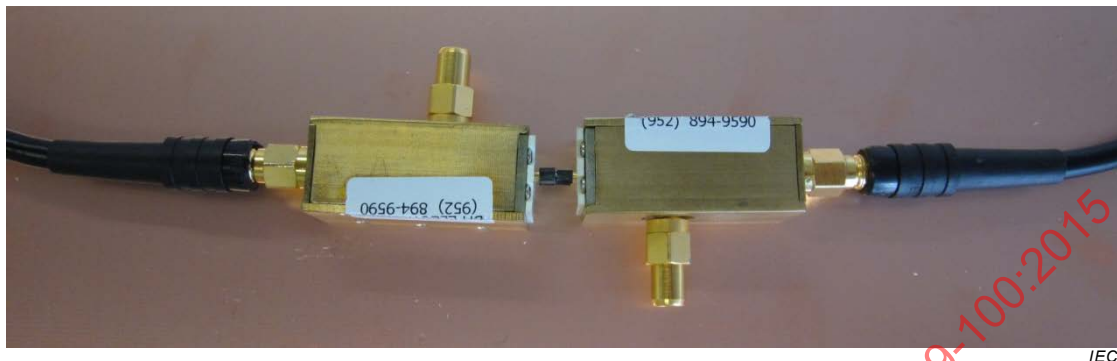
Figure 21 – Mesure de la perte d'insertion de symétriseurs placés dos à dos
