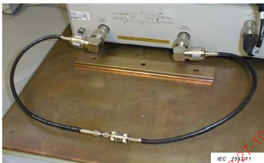
Figure 10 – Etalonnage de l'affaiblissement des fils coaxiaux
