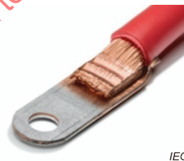
Figure 14 – Exemple 3 de soudage par ultrasons sur des sorties
