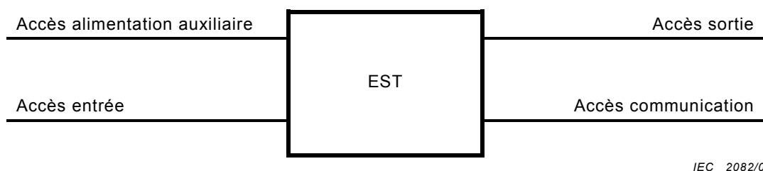
Figure 1 – Accès essayés dans la présente norme pour les relais de mesure et dispositifs de protection
