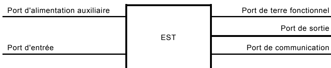
Figure 1 – Ports essayés dans la présente norme pour les relais de mesure et les équipements de protection
